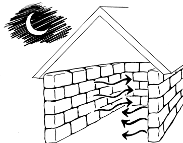
នៅពេលព្រះអាទិត្យលិចចាត់ កម្ដៅចេញពីជញ្ជាំងនិងកម្រាល ចូលទៅក្នុងបន្ទប់។
