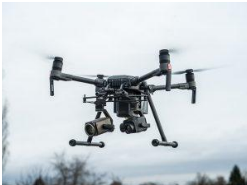
Figure 20-8: DJI Matrice 210 V2 With Zenmuse XT2 Thermal & Zenmuse Z30 Visual
